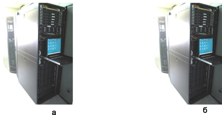
а - хранилище информации на 220 ТБ; б - устройство резервного копирования. Рисунок 3. Вычислительный кластер из 10 серверов (производительность 1 Тфлоп/с)
