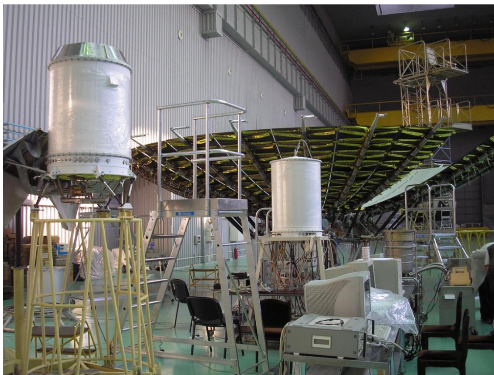
Рисунок 4. Фокальный (слева) и приборный (справа) контейнеры КРТ
